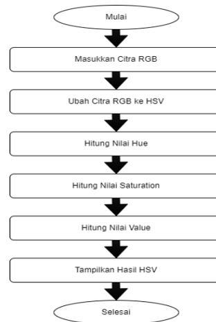
Gambar 3.3. Alur mengubah RGB ke HSV
